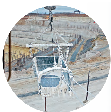
▲ Благодаря длинной стреле шагающий экскаватор быстро формирует так называемые «полки» — площадки уступов карьера
