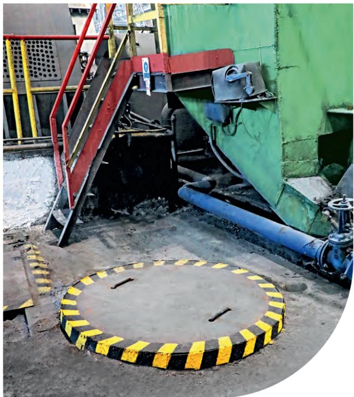
▲ На секциях мельниц участков цеха обогащения есть специальные монтажные проёмы. Износившиеся защитные крышки таких люков обновили и обозначили яркой маркировкой. Безопаснее стал не только труд ремонтников: фабричный персонал и подрядчики сразу замечают препятствие и избегают спотыканий.
