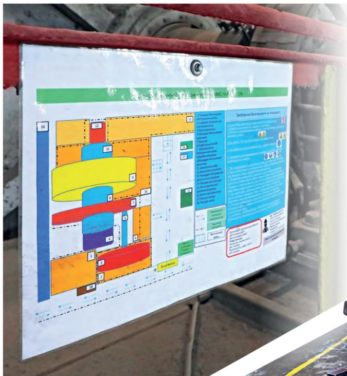
▶ Теперь зоны размещения материалов и запчастей отмечают жёлтыми лентами или линиями. Для крупногабаритных деталей есть даже специальные боксы. Материалы распределяют по типам. В планах — более детализированное разделение, например, новых и б/у запчастей.
