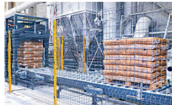
▲ Сотрудникам необходимо своевременно заполнять «магазины» агрегата мешками и следить за работой линии
