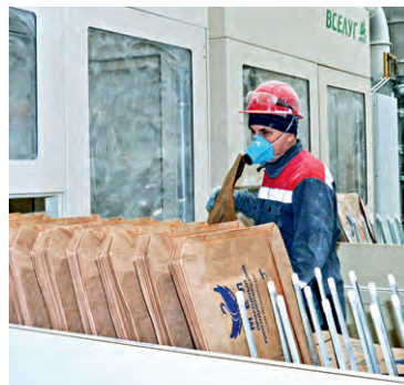
▲ Сотрудникам необходимо своевременно заполнять «магазины» агрегата мешками и следить за работой линии
