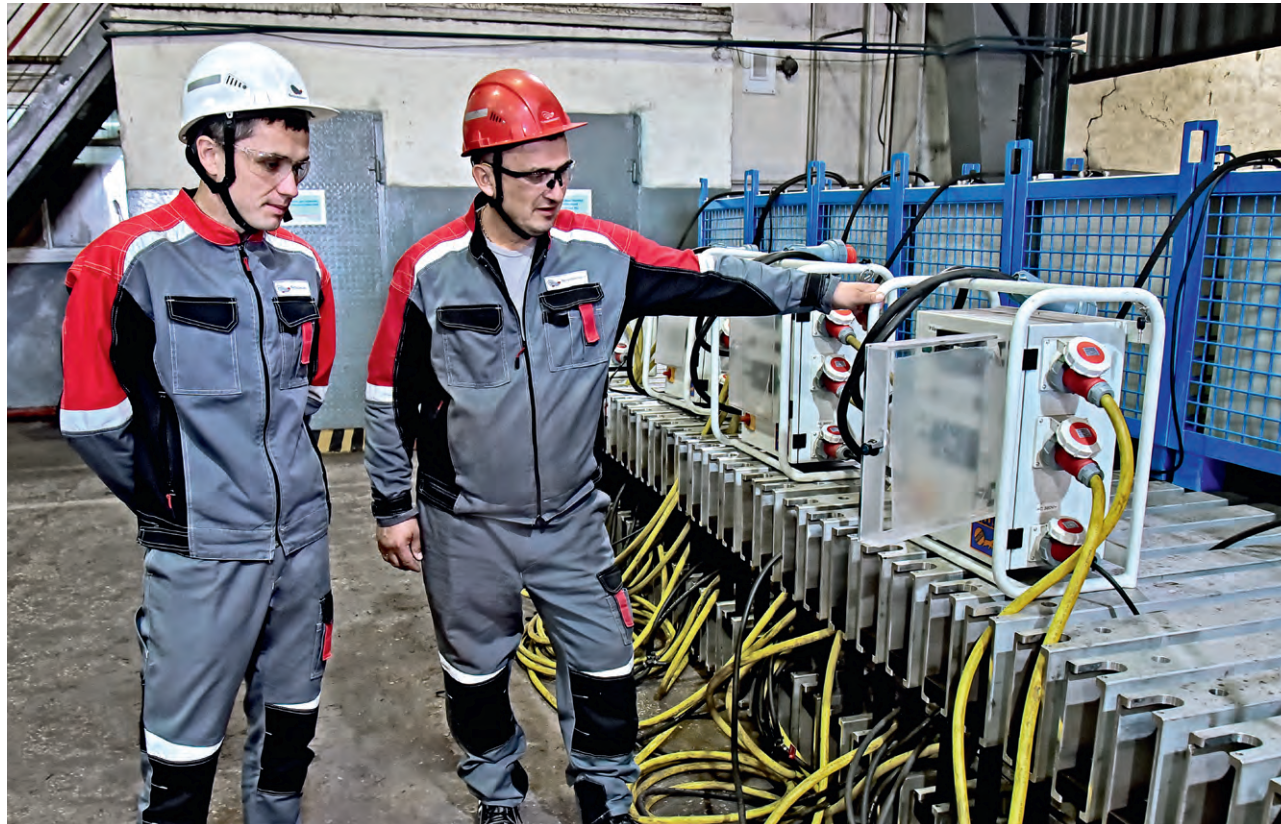
▲ Специалисты участка по ремонту конвейерных лент при помощи шкафов управления задают температуру и время вулканизации. На каждом прессе предусмотрено пять таких устройств
