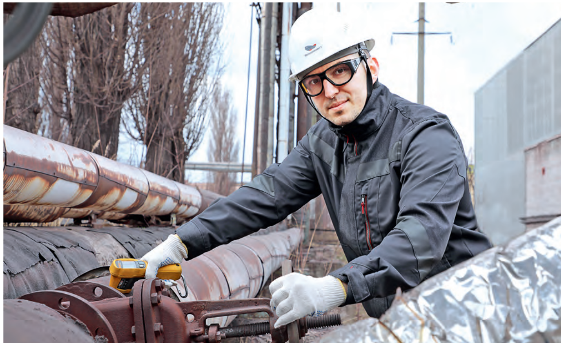
▲ Андрей Дейнеко проводит время не только за расчётами в кабинете. Нередко он выходит и «в поля» — например, чтобы с помощью пирометра замерить температуру ограждающих конструкций
