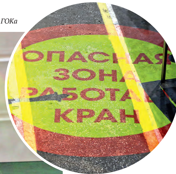
▲ Сигнальную надпись «Опасная зона. Работает кран» проецируют через специальную линзу
