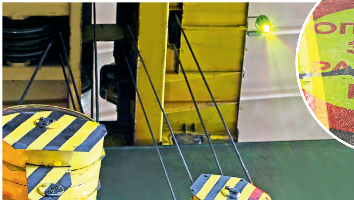
▲ Сигнальную надпись «Опасная зона. Работает кран» проецируют через специальную линзу
