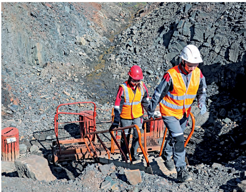
▲ Новые лестницы с прочными перилами — гарантия того, что при спуске и подъёме гидрогеологи защищены от травм
