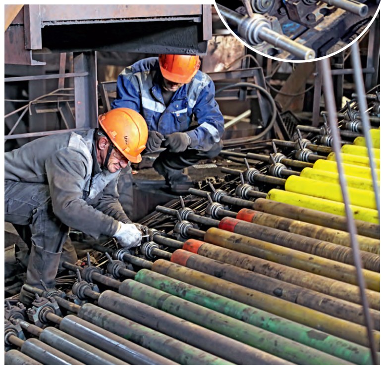
▲ Роликовый питатель уже отслужил срок, поэтому пришлось полностью менять все его элементы
