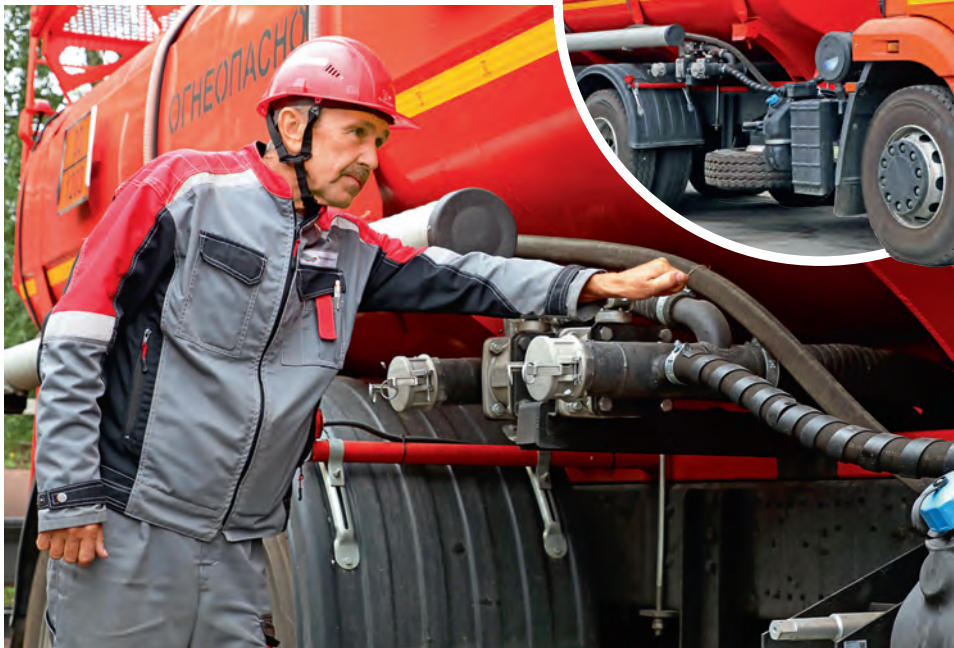
▲ Новенький топливозаправщик ёмкостью 15 кубометров за один — два рейса в смену «закрывает» нужды комбината в топливе...
