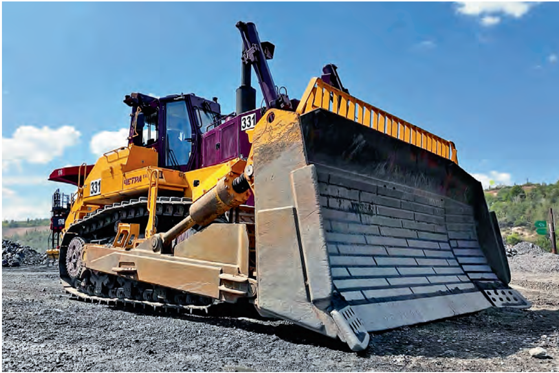
▲ Бульдозер ЧЕТРА Т40 — самый большой представитель этого типа техники на вооружении лебединских горняков. Его отвал по величине сравним с футбольными воротами
