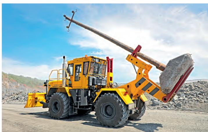
◀ Горная техника требует много энергии, поэтому за ней следуют и линии электропередачи. Для перемещения опор для проводов используют специальные машины — опороперевозчики. В прошлом году их парк пополнил шестой по счёту. Новобранец вооружён не только захватом, но и «лопатой», с помощью которой можно выровнять площадку для бетонного основания опоры или убрать мешающие установки просыпи. Эту модель «Кировца» укомплектовали рамкой для защиты капота и радиатора от удара в случае падения бревна.
