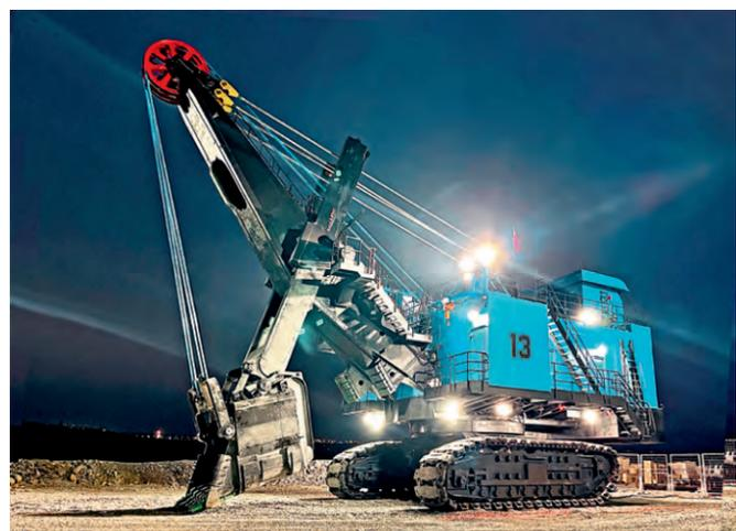
▲ Сразу на нескольких монтажных площадках шла сборка «разнокалиберных» экскаваторов — от юрких 12-кубовых до гигантского WK-35 с объёмом ковша 25 кубометров. Новые экскаваторы оснащают системой сигнального освещения опасной зоны при ведении горных работ в тёмное время суток.
