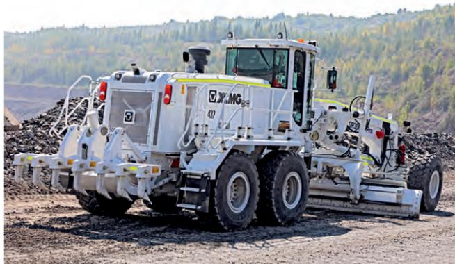
В автоколонне № 4 АТУ шесть автогрейдеров — с их помощью в карьере расчищают дороги, отвалы, делают подъезды для большегрузов. Парк дорожных машин регулярно обновляют. Вот и в 2024 году новый автогрейдер заменил отработавшего срок собрата. Благодаря мощному двигателю производительность «новичка» выше: он в два раза быстрее разравнивает щебень, выгружаемый БелАЗом.
