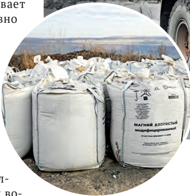
▲ Смесь хлористого кальция и воды закачивают в цистерны поливальных машин и орошают карьерные дороги. Тестируют и другое противогололёдное средство: хлористый магний уже поступил на комбинат
