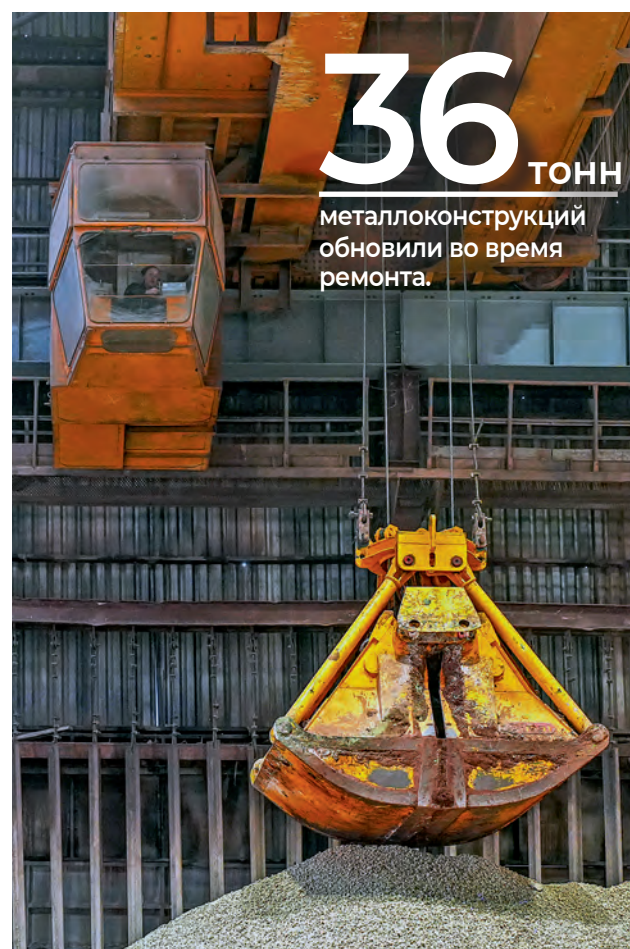
▲ Мостовой кран в корпусе по приёму бентонита обеспечивает разгрузку вагонов с флюсующими материалами и перемещает их на тракт измельчения
