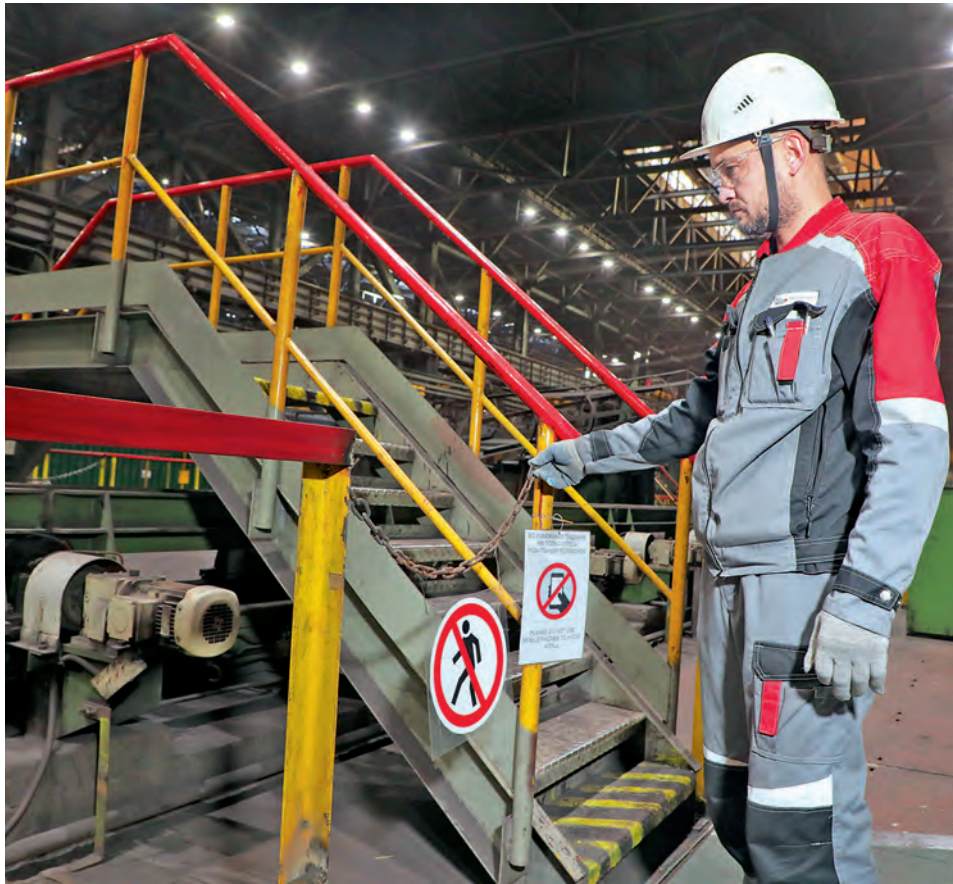
▲ В сортопрокатном цехе № 2 обеспечили безопасный доступ к датчику наличия металла на секции рольганга
