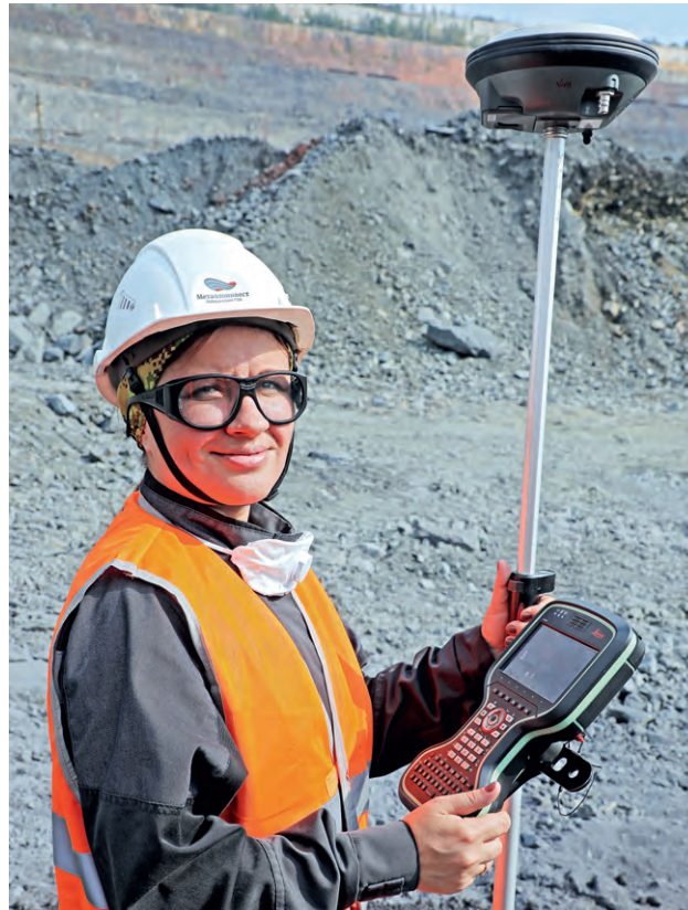
▲ Лёгкий и компактный GPS-приёмник стал спасением для хрупких маркшейдеров и вдвое сократил время исследования скважин
