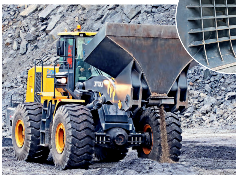
▲ Новый погрузчик оснастили специальным ковшом с шибберной заслонкой, регулирующей подачу забоечного материала в скважину
