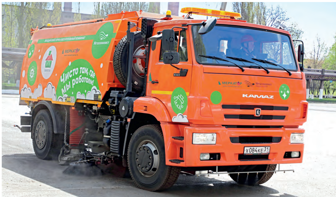
▲ Подметально-вакуумная машина предназначена для очистки автомагистралей от пыли и мусора
