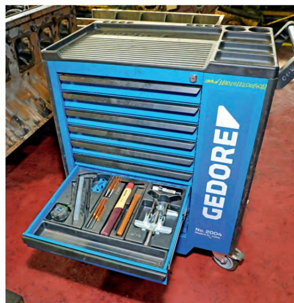
► Капремонт импортных двигателей требует набора специализированных приспособлений. Для них приобрели инструментальный ящик. В компактной металлической конструкции с выдвижными полками удобно и, как говорят, «под рукой» разместили всё, что может потребоваться для восстановления узла: ключи и головки разных размеров. Заказали и ждут поставку стенда для проверки форсунок двигателя — новое оборудование поможет проверять исправность комплектующих на месте, а не возить их для диагностики подрядчикам.
