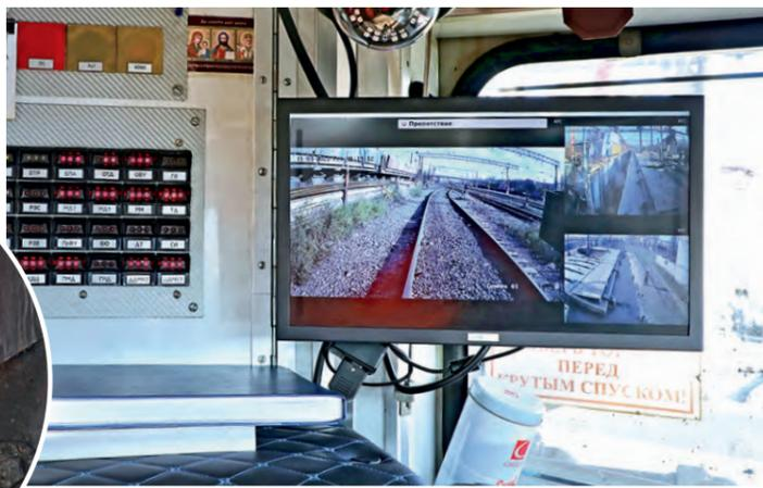
▲ На монитор выводятся изображения с «хвостовой» и ещё двух видеокамер с кабины тягового агрегата
